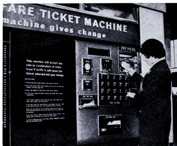
Nærbillede af billetautomaten. Møntindkast øverst til højre. Trykknapper svarende til forskellige takststørrelser underneden. Til venstre for trykknapperne er samtalemikrofon til oplysningscentralen.
